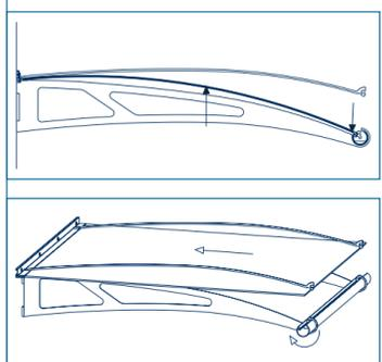
Простой монтаж с помощью защелки: акриловое стекло вводится в шпунт водостока – затем клемма стопорится и заворачивается колпачком из нержавеющей стали.
